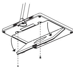
Durch Lösen der beiden Schrauben (2 mm Inbusschlüssel) auf der Unterseite lässt sich der Akku aus dem Gehäuse entfernen. Die Leuchte funktioniert auch ohne Akku weiterhin am Magnetic Dock bzw. über eine Stromversorgung am USB-C-Port. In diesem Fall pulsieren die Anzeige-LED der Batteriezustandsanzeige in rot (s. Seite 6). Für einen **RESET** der Leuchte den Akku entfernen, kurz warten und dann wieder einsetzen.
