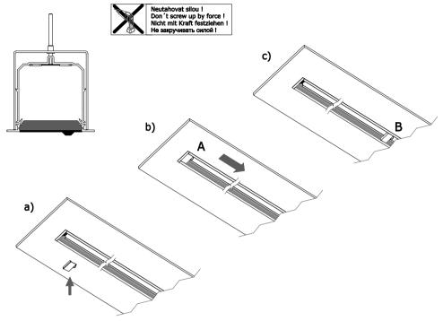
Po správné montáži je posuv testeru hladký (bez drhnutí). After correct assembly is moving the tester clear (without rubbing). Nach richtiger Montage ist Kontrollerbewegung kontinuierlich (ohne Abrieb). При правильном монтаже, контролёр передвигается гладко ( без задирания ).
