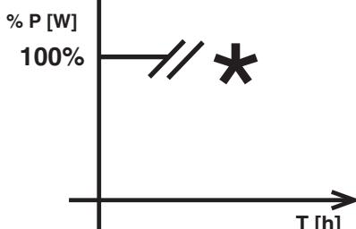
**A** Il profilo di dimmerazione notturna definito nel programma fa riferimento alla media annua della metà notte, che viene calcolato in base all'alba ed al tramonto teorici. Per ottenere un riconoscimento corretto dell' orario alba-tramonto si consiglia di adottare sistemi di accensione e spegnimento del prodotto più fedeli possibile al calendario astronomico, es. fotocellula o timer collegato al calendario astronomico.
