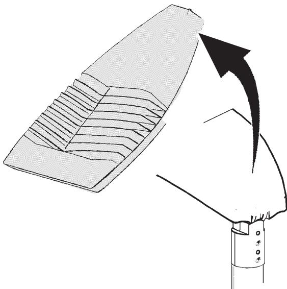
**I** E' possibile sostituire la singola cella di Leds non funzionante, contattare la iGuzzini.
