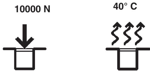
I Gli apparecchi sono stati progettati e collaudati per reggere un carico statico fino a 10000N (in funzione della controcassa), per installazioni in zone esclusivamente pedonali o ciclabili.
