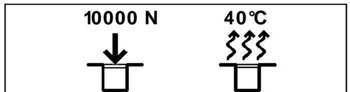
I Gli apparecchi sono stati progettati e collaudati per reggere un carico statico fino a 10000 N (in funzione della controcassa), per installazioni in zone esclusivamente pedonali o iclabili. La bassa temperatura superficiale (40°C), non crea limitazioni d'installazione.
