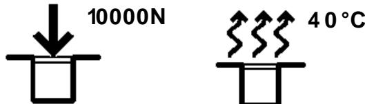
I Gli apparecchi sono stati progettati e collaudati per reggere un carico statico fino a 10000 N, per installazioni in zone esclusivamente pedonali o ciclabili. La bassa temperatura superficiale (40°C) non crea limitazioni d'installazione.
