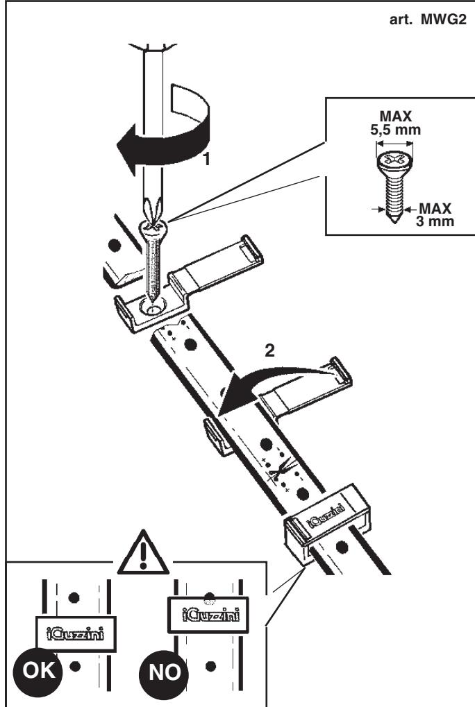
SOSTITUZIONE DEL LED
