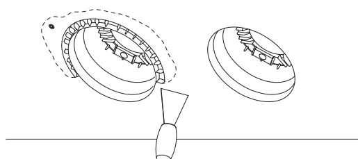
Stuccare perfettamente i bordi della cassaforma in modo da uniformare la finitura del soffitto con l'interno della cassaforma.
