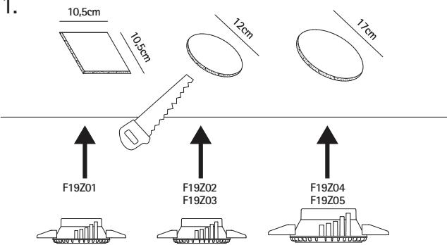
Scegliere la dimensione del foro da fare sul cartongesso in base al tipo di cassaforma.
