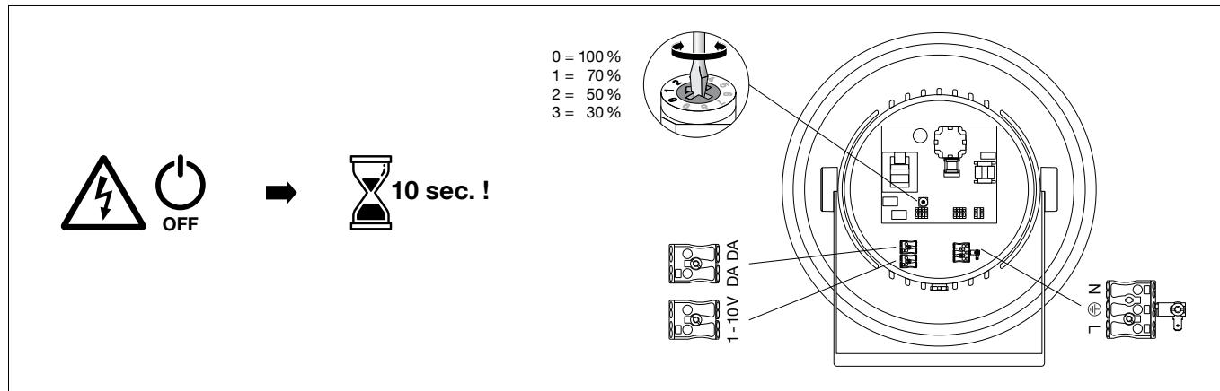
Schutzleiterverbindung zum Anschlussgehäuse herstellen (Steckerverbindung) und Deckel so auf das Anschlussgehäuse montieren, dass die Wasserablaufbohrungen im Gehäuserand nach unten gerichtet sind.
