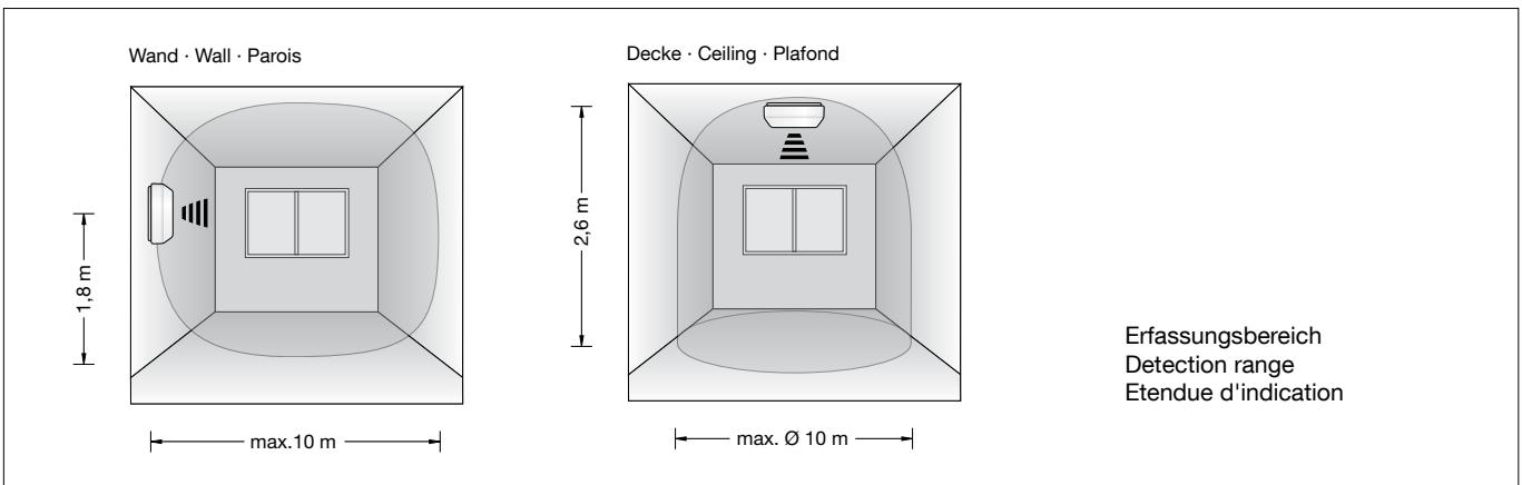
Die max. Wandmontagehöhe beträgt 2,7 m, die max. Deckenmontagehöhe beträgt 4,0 m, wobei die Reichweite deutlich weniger wird. Die Reichweite kann individuell eingestellt werden - Taste "Empfindlichkeit". Es ist zu beachten, dass Metallteile, die in naher Umgebung der Leuchte montiert sind, die Reichweite beeinträchtigen können.
