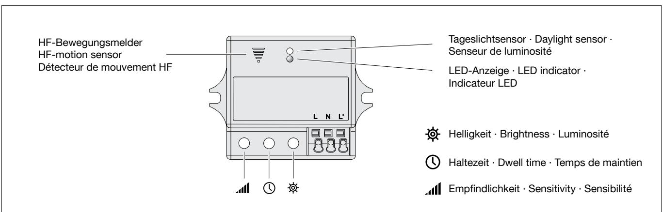
Der eingebaute Bewegungssensor arbeitet mit einer Frequenz von 5,8 GHz.
