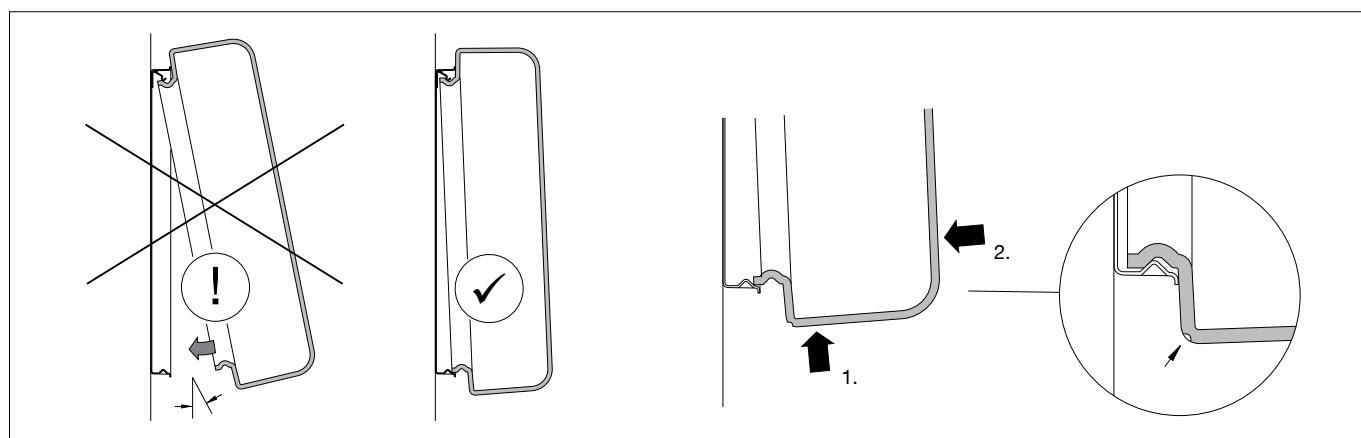
Glas in der Weise auf das Leuchtengehäuse aufsetzen, dass die Haltefedern in die beiden Aussparungen des Stehrandes des Glases passen.
