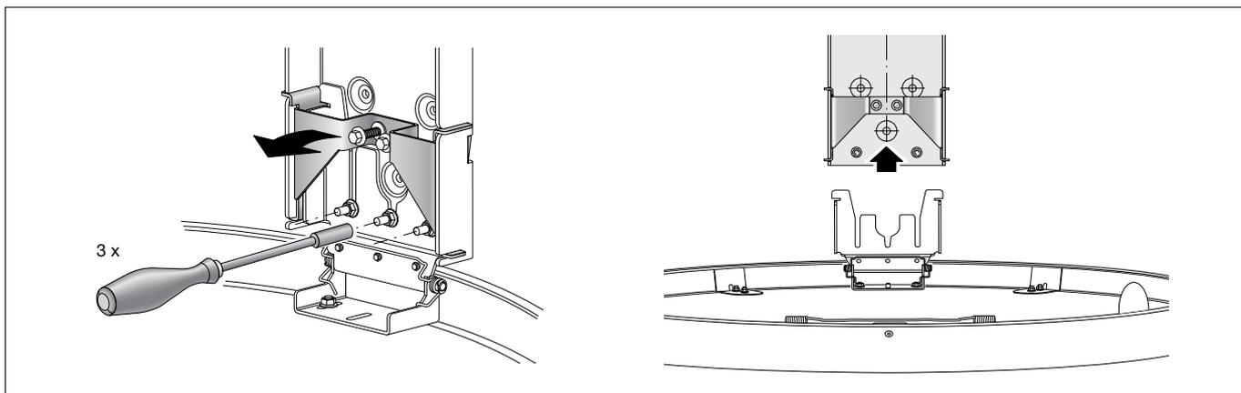
Deckenbügel vorsichtig aufstellen und LED-Steckverbindungen links und rechts lösen. 3 Muttern oberhalb des Deckenbügel-Scharniers mittels eines Steckschlüssels (Gr. 8) oder einer Knarre bis zum Gewindeende herausdrehen. Sicherungsbügel entgegen des Federdrucks nach vorne ziehen und Deckenbügel nach oben entfernen.
