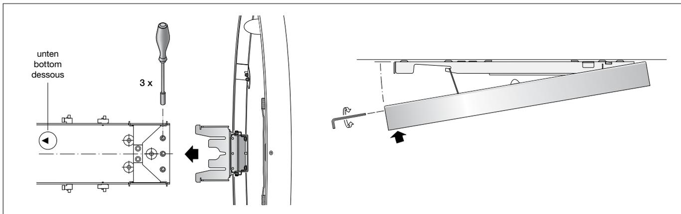
Bei Wandmontage Gebrauchslage der Leuchte "Pfeil unten" beachten. Der Sicherungsbügel muss nach oben zeigen! Deckenbügel mit beiliegendem oder anderem geeigneten Befestigungsmaterial am Montagegrund befestigen. Netzanschlussleitung durch eine der 4 Leitungseinführungen in den Deckenbügel führen. Schutzleiterverbindung herstellen und elektrischen Anschluss an Klemmen vornehmen.
