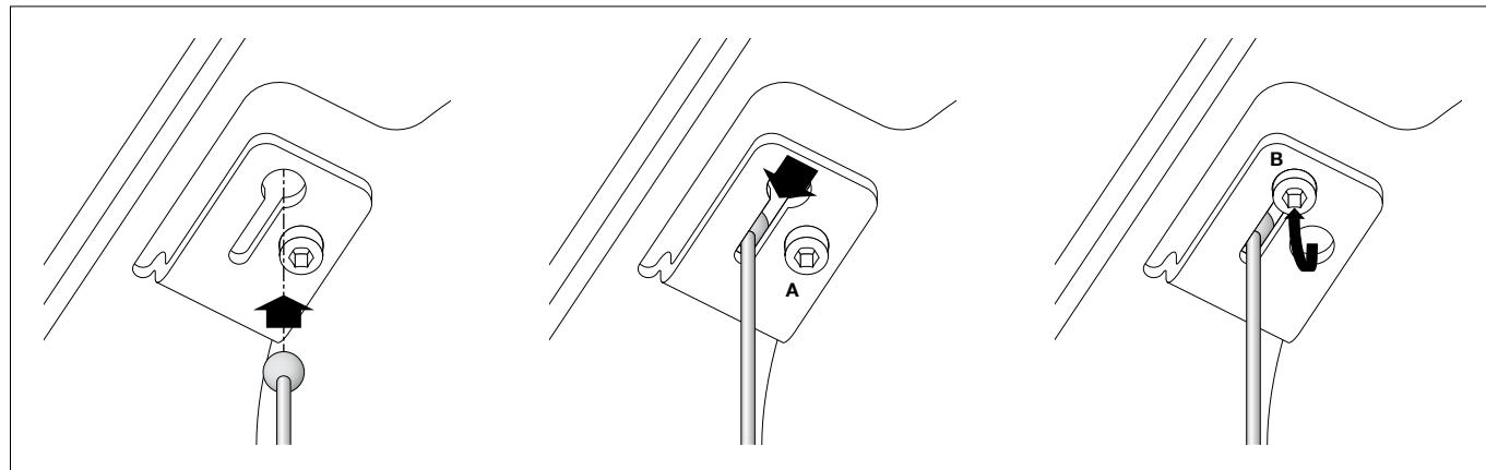
Stahlseilende vom Leuchtengehäuse in die Aussparung der Montageplatte einhängen. Innensechskantschraube (Pos. A) zur Sicherung des Stahlseils in die Bohrung (Pos. B) einschrauben.
