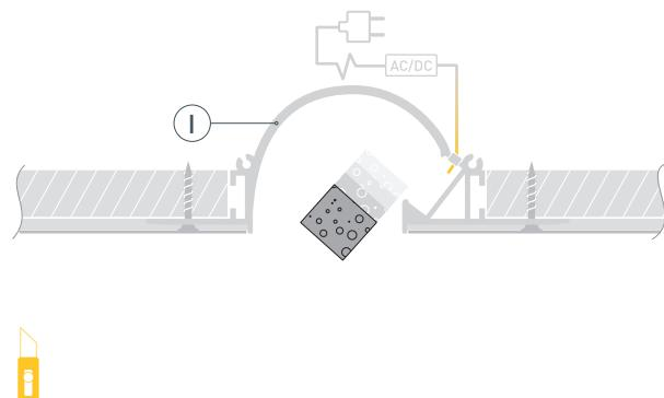
**5** / Установите светодиодную ленту **III** в профиль **I**. Подключите светодиодную ленту **III** к источнику питания, строго соблюдая полярность, обозначенную на плате светодиодной ленты. Максимально допустимая для подключения длина отрезка светодиодной ленты указана в инструкции к светодиодной ленте. Для обеспечения равномерного свечения ленты по всей длине рекомендуется подавать питание на светодиодную ленту с двух сторон.
