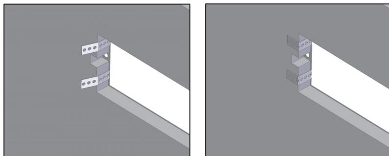
Inserire nel controsoffitto l'accessorio e piegare le lingue forate al di sotto per evitare che l'accessorio sia spinto verso l'alto durante l'inserimento dell'apparecchio
