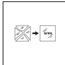
**ITA.** Sostituire il vetro/diffusore con ricambio originale ARES in caso di rottura.
