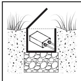
**ITA.** Il complesso di alimentazione deve essere installato all'interno di idonei pozetti con drenaggio dell'acqua.
