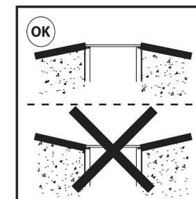
**ITA.** Evitare l'installazione in avallamenti o in punti di ristagno d'acqua.
