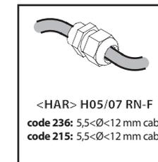
**ITA.** Utilizzare un cavo di alimentazione con tipologia idonea (cavi flessibili HAR H05/07 RN-F o idonei per l'utilizzo all'esterno): i cavi rigidi possono compromettere la tenuta attraverso il pressacavo.
