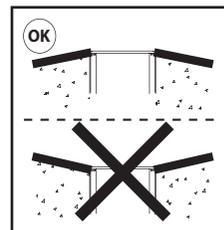
**ITA.** Evitare l'installazione in avallamenti o in punti di ristagno d'acqua.
