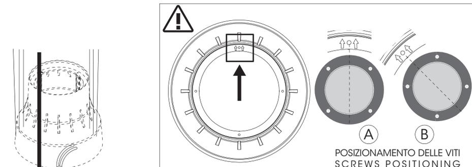
In fase di installazione della cassaforma codice 188, prestare attenzione al senso di posizionamento della freccia stampata sulla cassaforma la quale determina un preciso orientamento delle viti presenti sulla ghiera della lampada.
