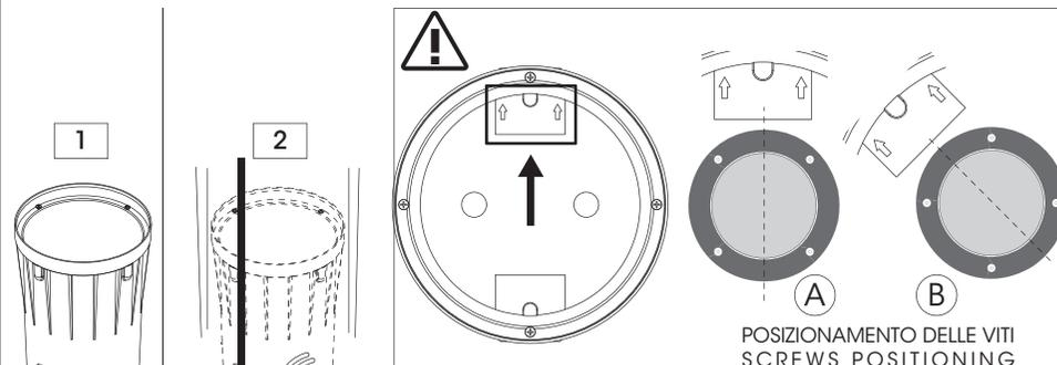
In fase di installazione della cassaforma codice 189-190, prestare attenzione al senso di posizionamento della freccia stampata sulla cassaforma la quale determina un preciso orientamento delle viti presenti sulla ghiera della lampada.
