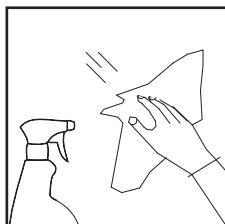
**IT.** Pulire periodicamente gli apparecchi per rimuovere gli accumuli di sporco che si depositano sulle griglie e nella testa delle viti. Pulire le parti in acciaio utilizzando appositi detergenti.
