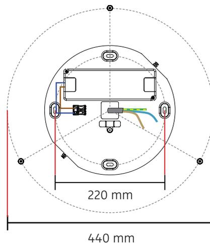
Deckenblech des Baldachins mittig montieren !
