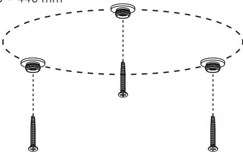
POSITIONIERUNG: Die Montagepunkte der Pendelseile definieren die exakte Position der Leuchte. Baldachin samt Deckenauslass sollten sich möglichst mittig zwischen den Pendelseilen befinden.
