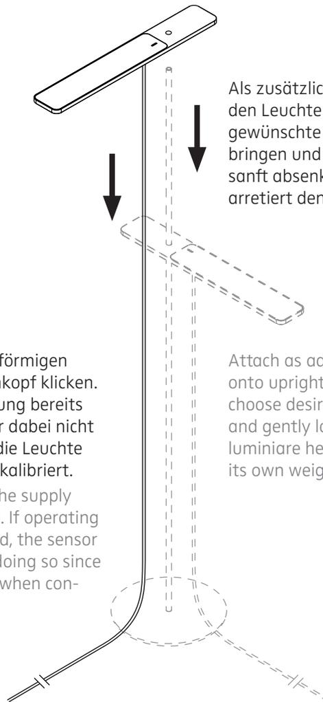
Als zusätzliches Lichtpaddel auf den Leuchtenstab setzen, in die gewünschte Höhe und Position bringen und den vorderen Teil sanft absenken: das Eigengewicht arretiert den Leuchtenkopf dort.
