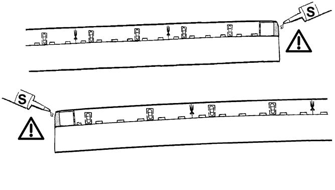
**I** N.B.: Il grado di protezione del sistema, è garantito soltanto se si effettua correttamente l'operazione di siliconatura (**S**) con silicone fornito dalla iGuzzini.
