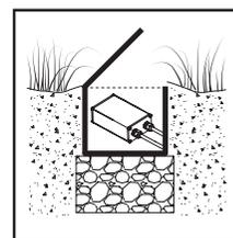
**ITA.** Il complesso di alimentazione (IP ≥67) può essere installato all'interno di idonei pozzetti con drenaggio dell'acqua.
