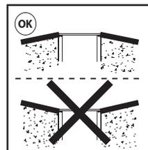
**ITA.** Evitare l'installazione in avvallamenti o in punti di ristagno d'acqua.
