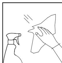
**ITA.** Pulire periodicamente gli apparecchi per rimuovere gli accumuli di sporco che si depositano sulle griglie e nella testa delle viti. Pulire le parti in acciaio utilizzando appositi detergenti.
