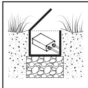
**IT.** Il complesso di alimentazione (IP  $\geq$ 67) può essere installato all'interno di idonei pozzetti con drenaggio dell'acqua.
